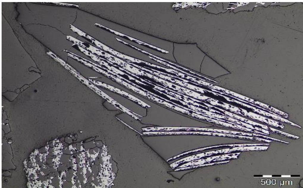
Figura 18 Amostras AGEOD 192 - Fotomicrografia, luz refletida, nicóis paralelos, objetiva 4X (500µm).
