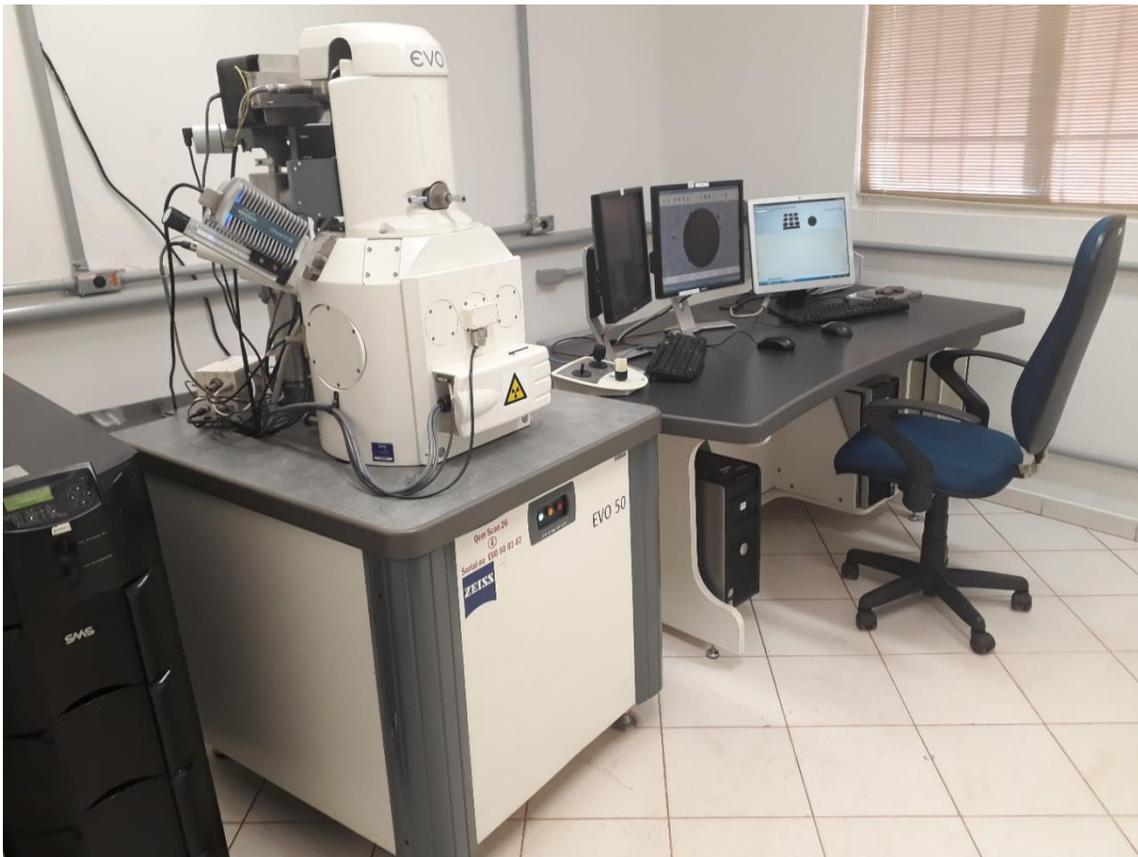
Figura 8 - Microscópio eletrônico de varredura (MEV) com EDS (QEMSCAN)
