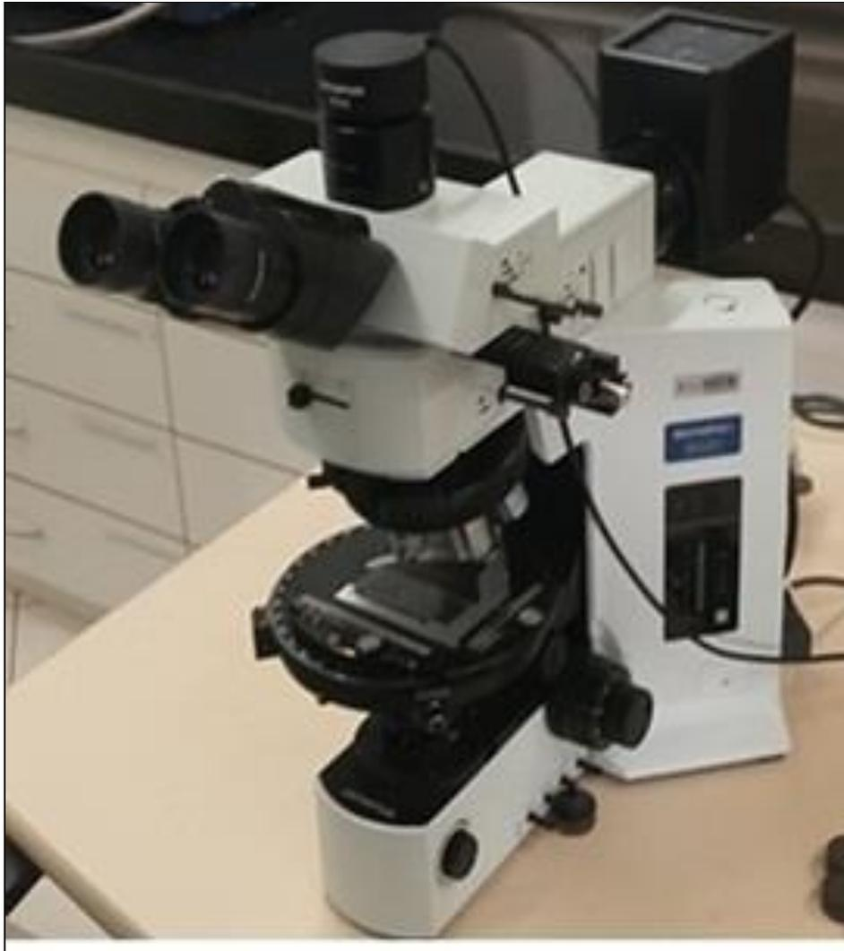
Figura 6 - Microscópio de luz refletida
