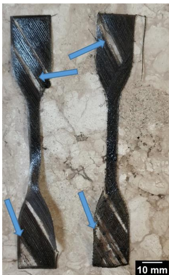
Figura 47: Erro de adesão irregular da primeira camada.
