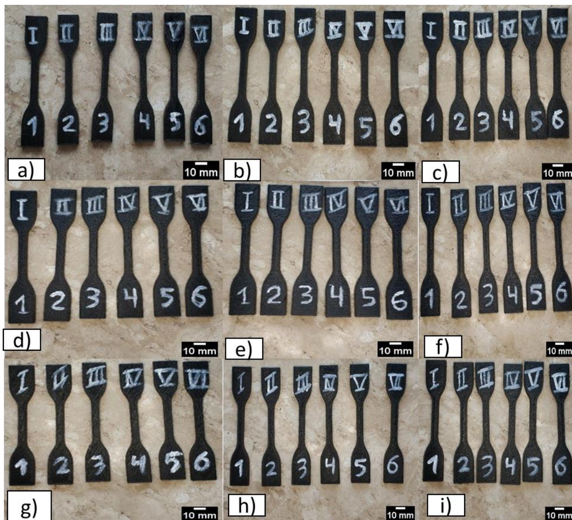
Figura 49: Fotos dos corpos de prova antes do ensaio de tração nas diferentes orientações de deposição de camada. a) Orientação 0°; b) Orientação 30°; c) Orientação 45°; d) Orientação 60°; e) Orientação 90°; f) Orientação 0-90°; g) Orientação 30-30°; h) Orientação 45-45°; i) Orientação 60-60°.
