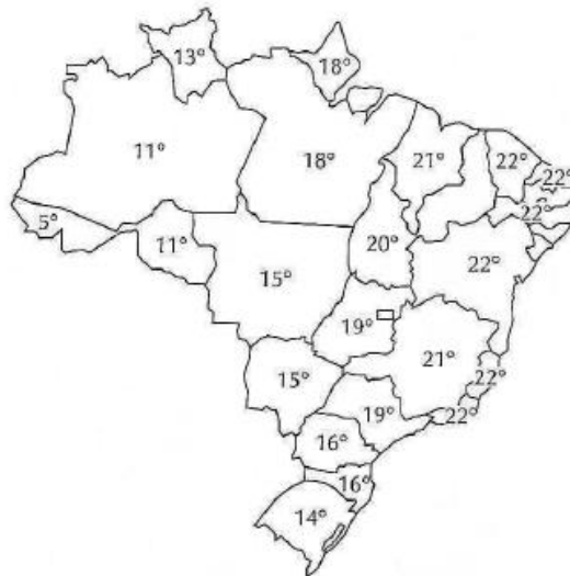
Figura 18 – Mapa de ângulos de correção para encontrar o norte geográfico, ou norte real (geográficos), a partir da indicação do norte magnético por uma bússola
