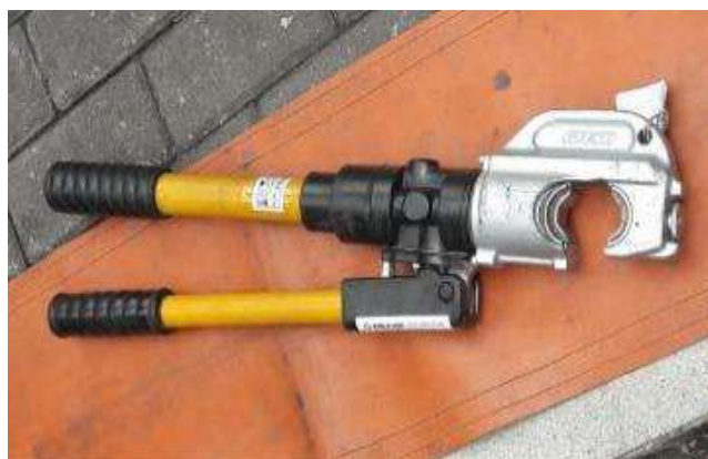
Figura 6. O Alicate hidráulico tipo Y35
