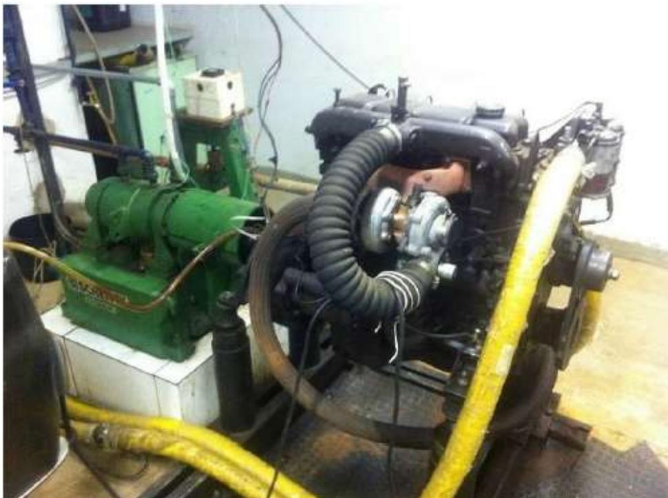
**Figura 2.17 – Set up experimental da bancada dinamométrica (ALBUQUERQUE, 2015).**
