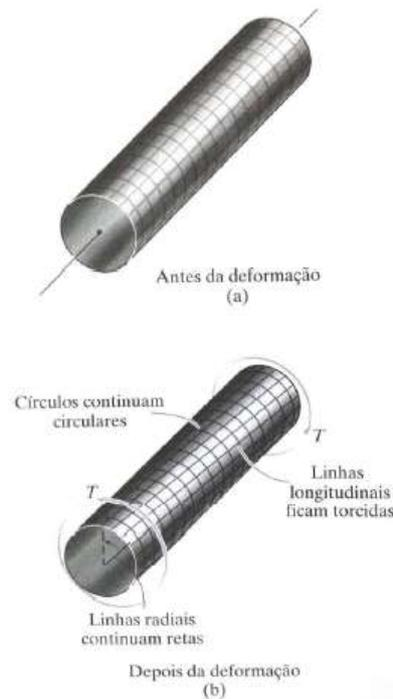
**Figura 2.11 – Ângulo de torção em uma barra sólida (HIBBELER, 2009).**
