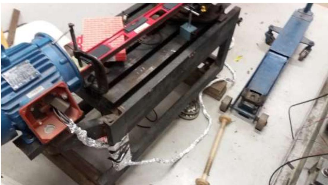
**Figura 3.13 – Alinhamento dos motores e do eixo de torção na bancada (Autor).**
