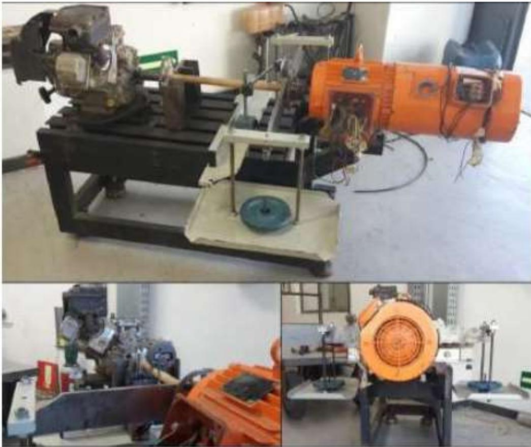
Figura 3.20 – Montagem para calibração estática do sistema (ARAÚJO, 2015).
