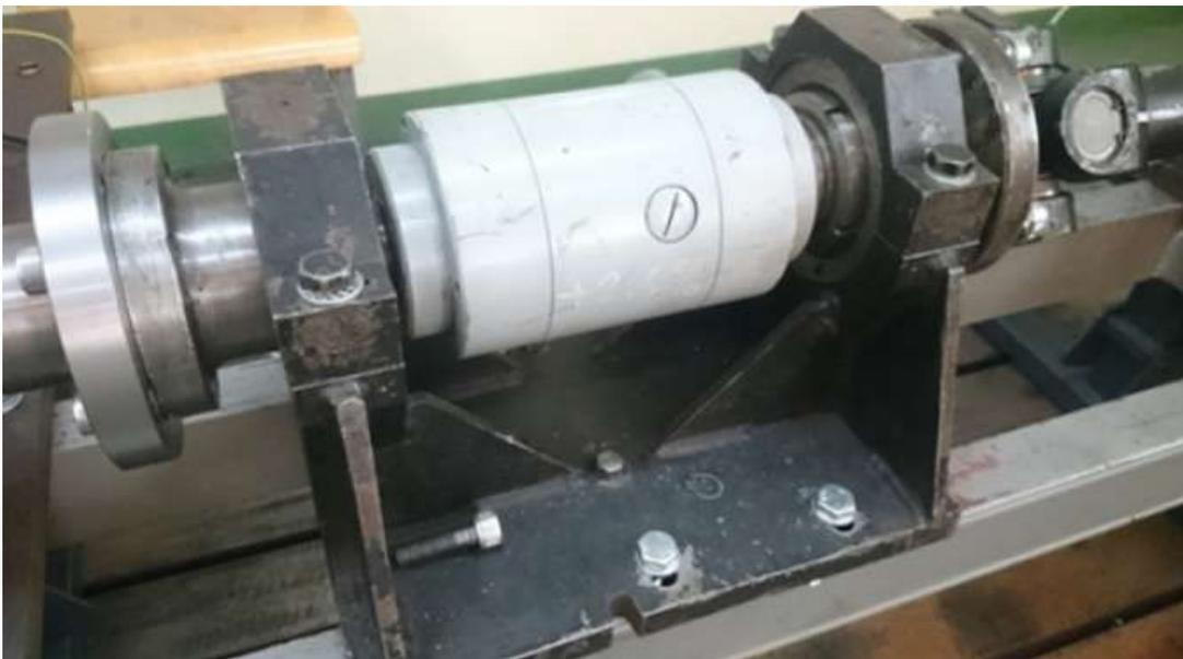
**Figura 2.24 – Torquímetro suspenso por dois rolamentos (GOSZCZAK, 2016).**
