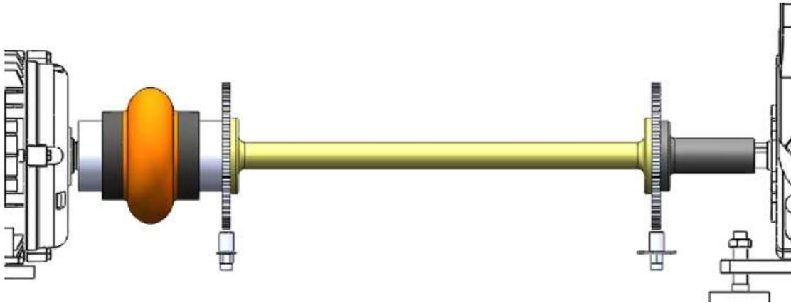
**Figura 3.17 – Desenho 3D da montagem do eixo de torção (MARTINS, 2013)**
