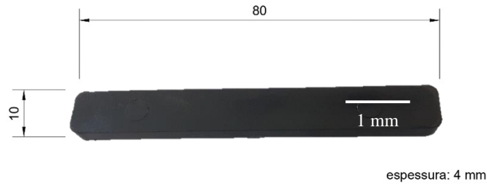
FIGURA 3.9 - Geometria e dimensões do corpo de prova padrão de flexão ensaiado
