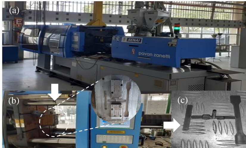
FIGURA 3.6 - Moldagem dos corpos de prova: (a) injetora Pavan Zanetti, (b) molde aberto e (c) corpos de prova injetados
