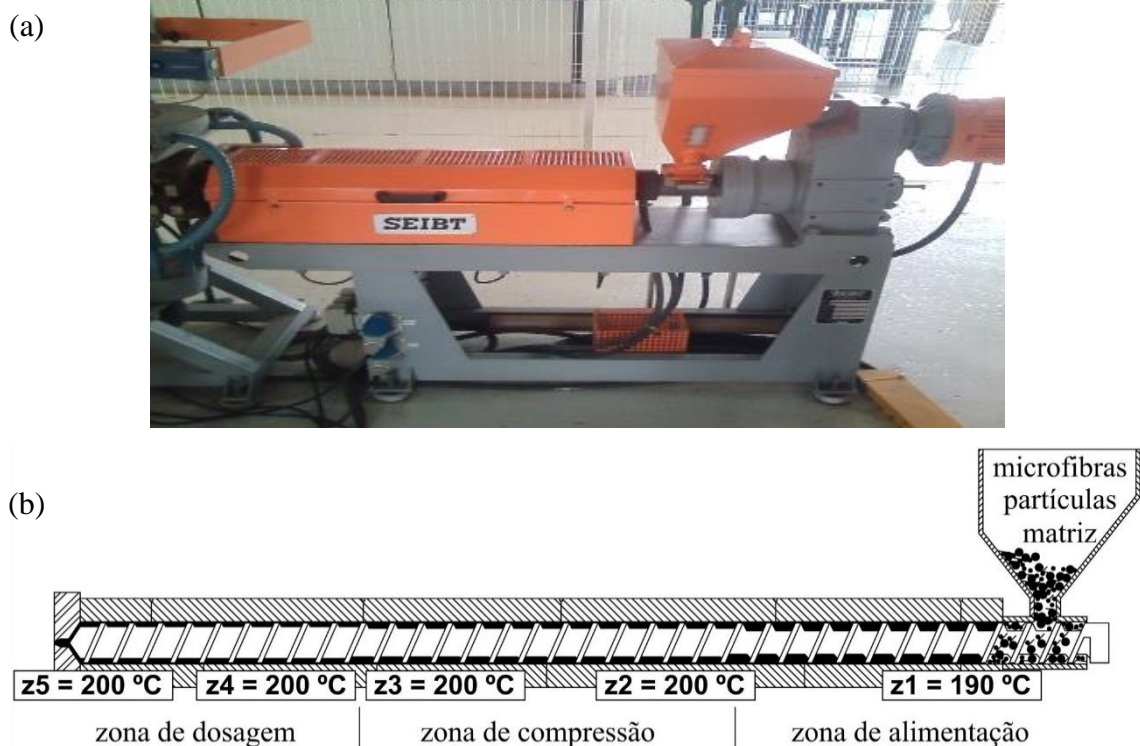
FIGURA 3.4 - Extrusão dos compósitos: (a) extrusora SEIBT e (b) configuração do canhão e rosca
