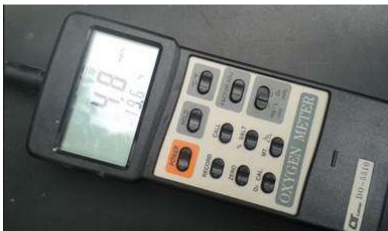
Figura 8: Aparelho utilizado para medir o parâmetro Oxigênio Dissolvido das águas do Córrego do Cardoso
