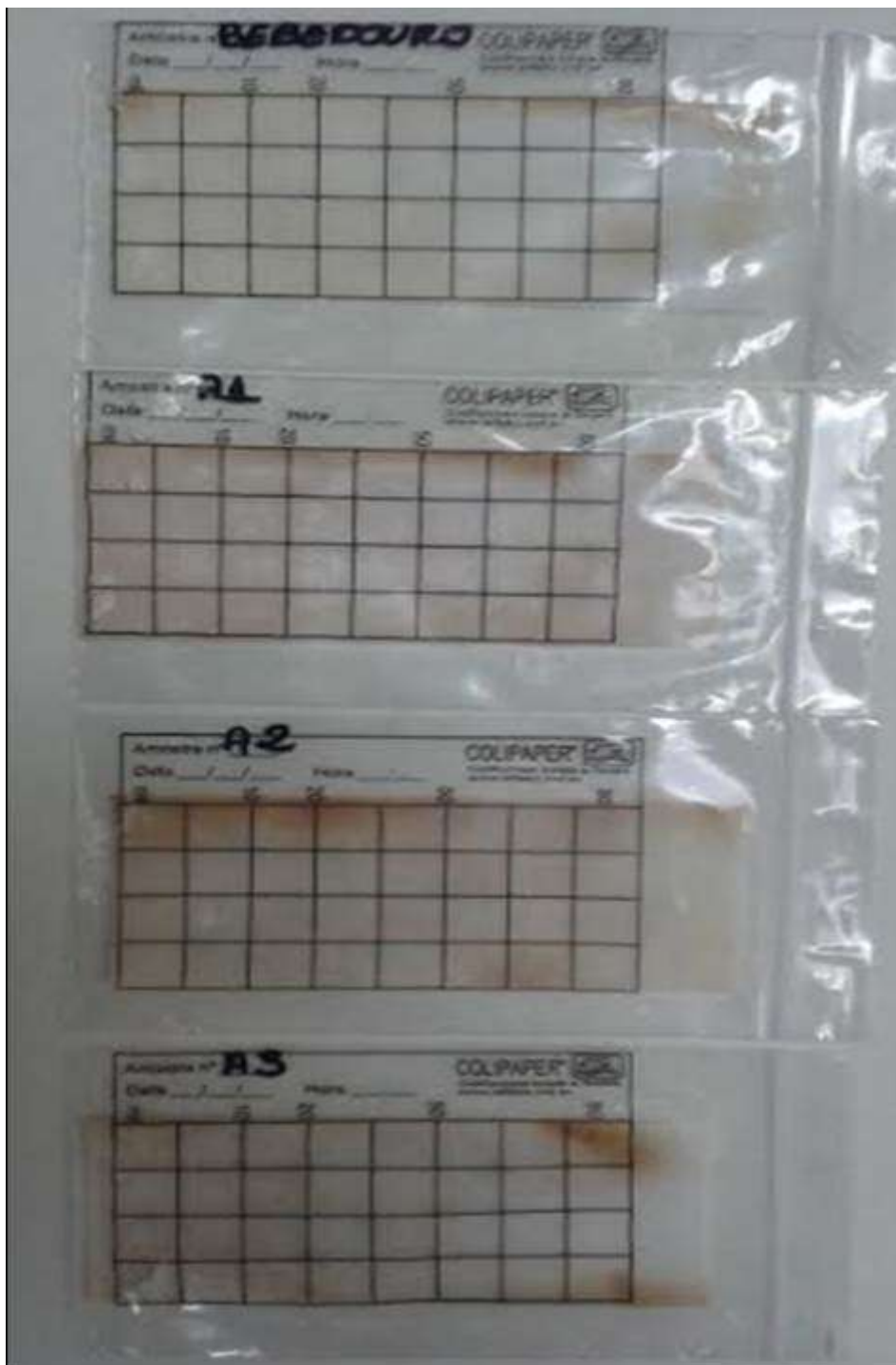
Figura 11: Teste Bacteriológico das águas do Córrego do Cardoso
