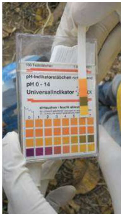
Figura 10: Parâmetro do pH das águas do Córrego do Cardoso sendo analisado
