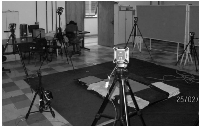
Figura 1 – Disposição das 11 câmeras do sistema de captura de movimento em torno das duas plataformas de força.
