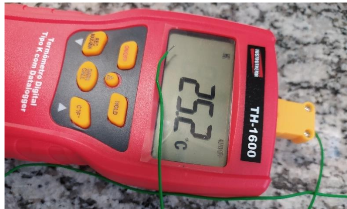
Termômetro Digital com certificação utilizado em todos os experimentos, exceção ao experimento utilizando micro-ondas.
