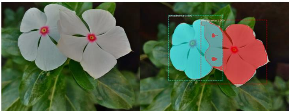
Figura 4 – Detecção e identificação da flor de vinca pela caixa delimitadora e máscara de segmentação
