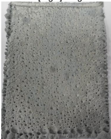
(d) 605Am^{-2} e [Mg^{2+}] = 1gL^{-1}
