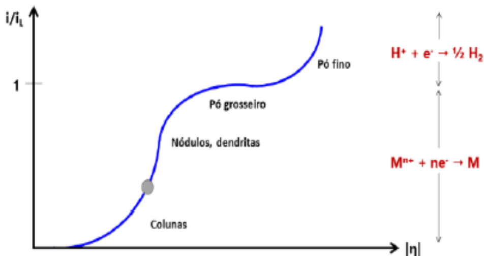
Figura 3.6. Diagrama esquemático i/i_L x sobrepotencial catódico destacando as diferenças nas características do depósito metálico (Adaptado de Nicol, 2007).
