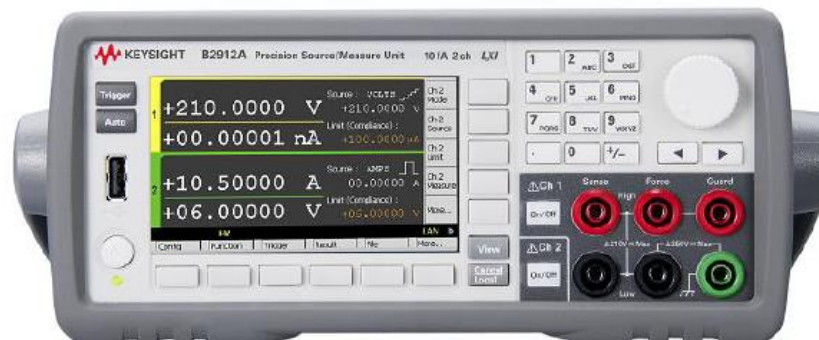
Figura 4.2. Fonte de corrente elétrica contínua utilizada nos ensaios de eletrorecuperação de zinco.
