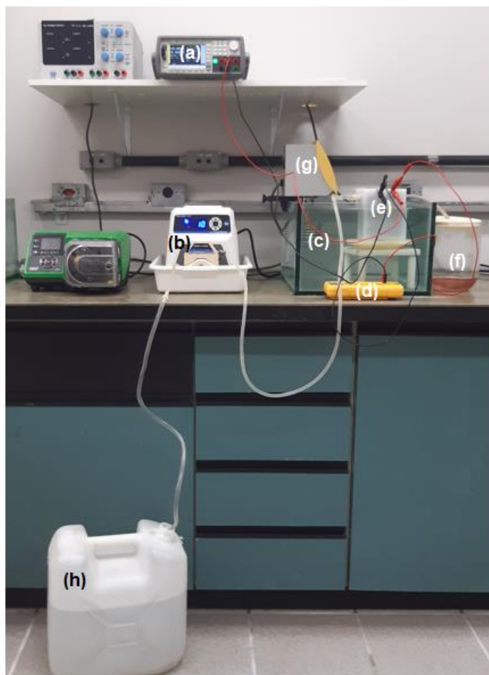
Figura 4.3. Aparato experimental utilizado nos ensaios de eletrorrecuperação de zinco: (a) fonte de corrente contínua, (b) bomba peristáltica, (c) banho de vidro temperado, (d) multímetro digital, (e) célula de polipropileno, (f) galão de plástico para armazenamento de solução exaurida de zinco, (g) termostato, (h)
