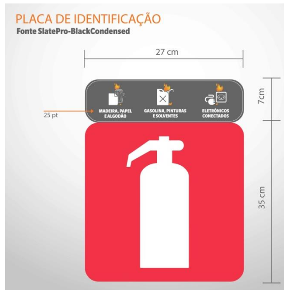
Figura 14: Placa de identificação com informativo dos tipos de materiais que o extintor pode atender.
