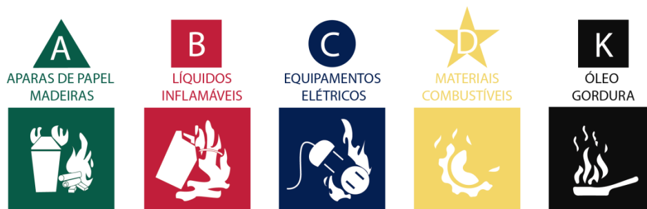
Figura 7: Sinalização indicativa do tipo de extintor, com pictogramas de classe de fogo.
