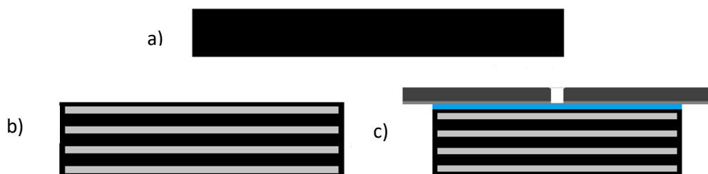
Figura 5 - Aparelhos de apoio elastomérico simples (a), fretado (b) e deslizante (c). Fonte: https://www.ctborracha.com/aparelhos-de-apoio-elastomericos/
