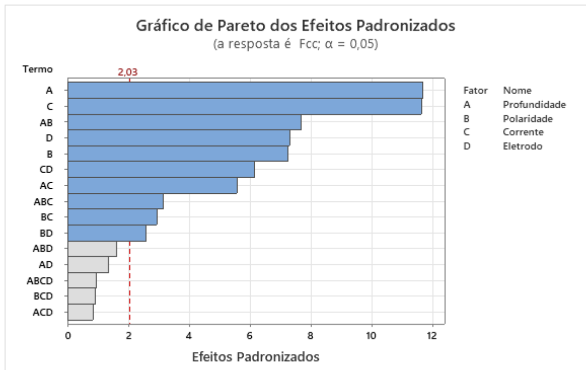
Figura 64 – Gráfico de Pareto dos Efeitos Padronizados para o Fator de Curto Circuito
