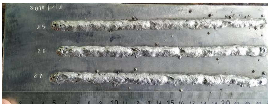
Figura 26 – Cordões de solda produzidos a 30m de profundidade, 180A, DCEP, E312
