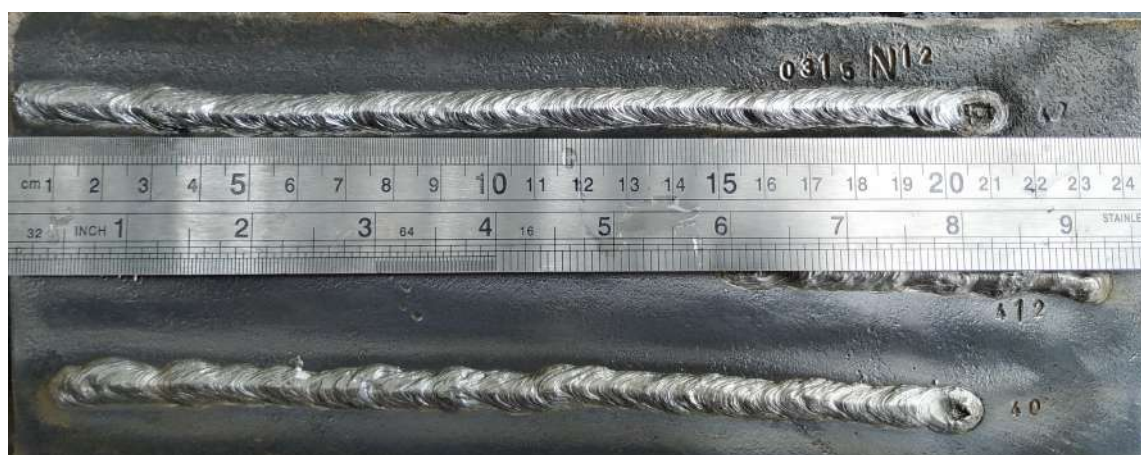
Figura 21 – Cordões de solda produzidos 0,3m de profundidade, 150A, DCEN, E312
