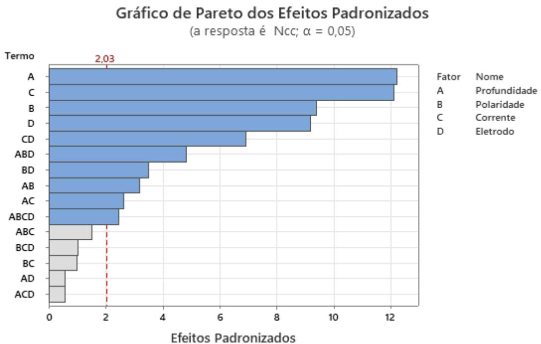
Figura 62 – Gráfico de Pareto dos Efeitos Padronizados para o Número de Curtos Circuitos.
