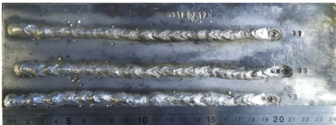
Figura 20 – Cordões de solda produzidos a 0,3m de profundidade, 180A, DCEN, E312
