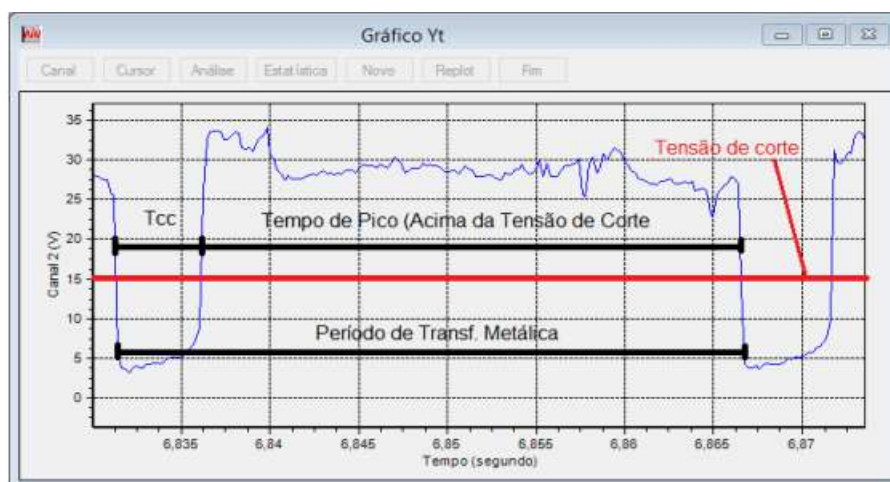
Figura 11 – Oscilograma aumentado mostrando valores de tensão média de curto circuito T_{cc} , duração média de pico T_p , período médio T , e tensão de corte.
