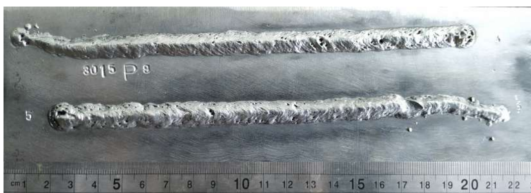
Figura 34 – Cordões de solda produzidos a 30m de profundidade, 150A, DCEP, E309
