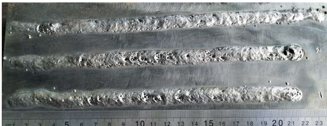
Figura 30 – Cordões de solda produzidos a 30m de profundidade, 180A, DCEP, E309
