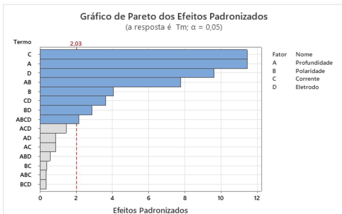
Figura 66 – Gráfico de Pareto dos Efeitos Padronizados para a Tensão Média de Soldagem
