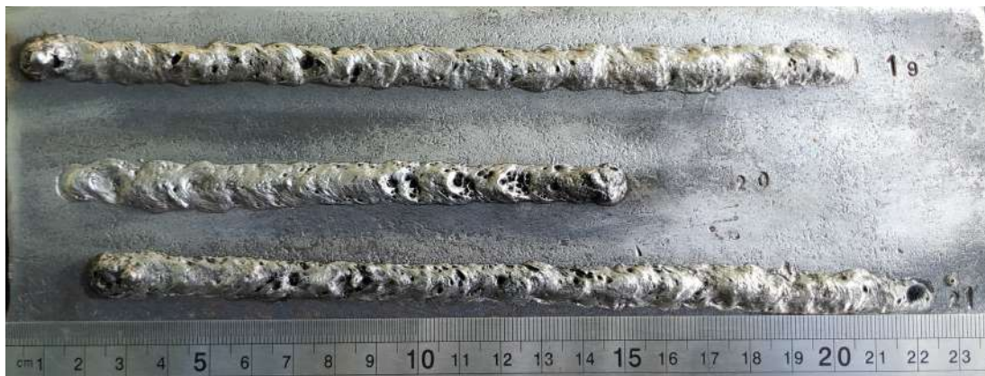
Figura 29 – Cordões de solda produzidos a 30m de profundidade, 180A, DCEN, E309
