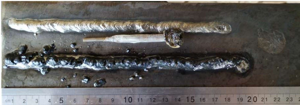
Figura 12 – Medição do cordão de solda e do comprimento do eletrodo pós soldagem.
