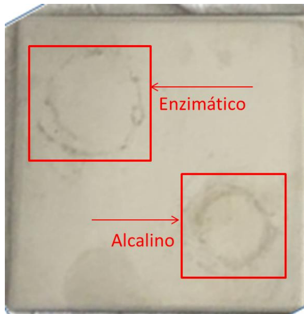
Figura 23 - Corpo de prova após ensaios eletroquímicos - Aço 316L
