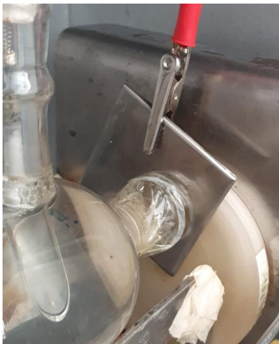
Figura 8 - Montagem da Célula Eletroquímica – Aproximação do Eletrodo de Trabalho
