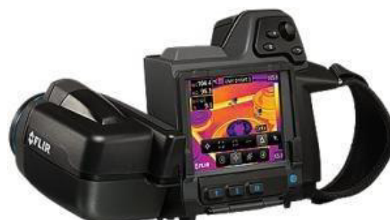
Figura 06: Câmera termográfica modelo FLIR T450s 2 .
