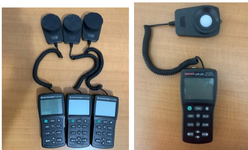
Figura 37 - Foto dos luxímetros ITLD-300 (à direita) e luxímetro de referência LDR 225 (à esquerda)
