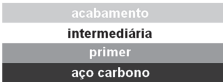
Figura 5 - Sistema de pintura aço carbono Fonte: COTTING (2017)
