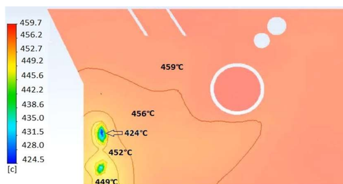
Figura 5.30 - Distribuição de temperatura após a fusão completa (7,7 min) do lingote inserido no banho de zinco.
