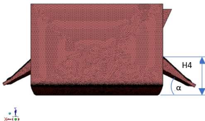
Figura 4.7 - Vista lateral do pote B com o posicionamento vertical dos indutores frontais à tira.
