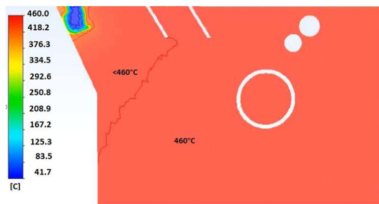
Figura 5.33 - Distribuição de temperatura com o lingote sólido a 40°C e 25% de imersão.
