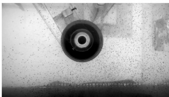
Figura 3.7 – Imagem do simulador físico a frio utilizado e publicada por FEI et al. (2021) para observar dispersão de bottom-dross .
