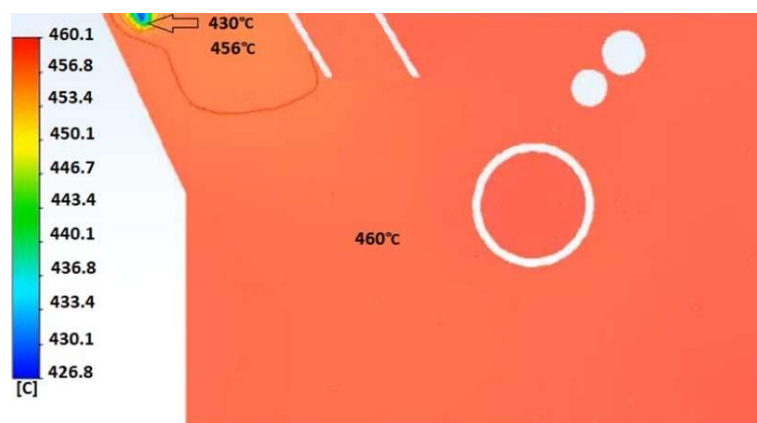
Figura 5.32 - Distribuição de temperatura depois da fusão do lingote (7,6 min) com 50% de imersão.
