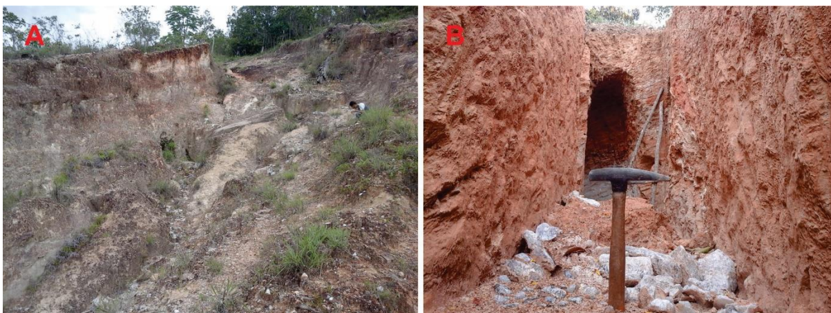
Figura 2.5: Vistas parciais da ocorrência da Fazenda Sobrado. A) Área de lavra mais antiga, abandonada. B) Escavações recentes com fragmentos de quartzo leitoso e hialino em meio ao xisto encaixante intensamente alterado.
