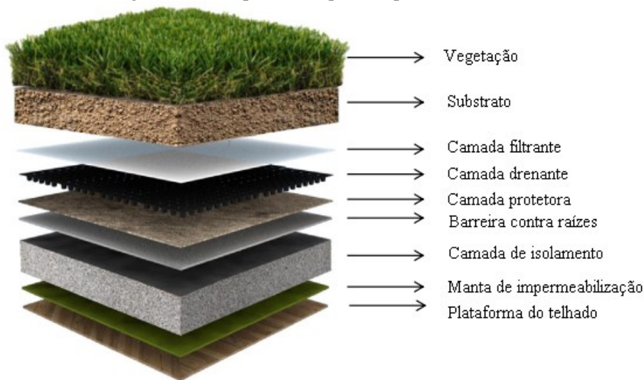
Figura 2 – Componentes que compõem o telhado verde
