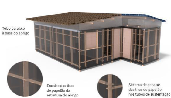
Figura 44: Vista da estrutura interna do abrigo. Fonte: elaborado pelos autores.
