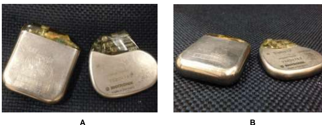
FIGURA 3 – Perfil de um modelo mais moderno de marca-passo cardíaco, comparado a um perfil de um modelo mais antigo
