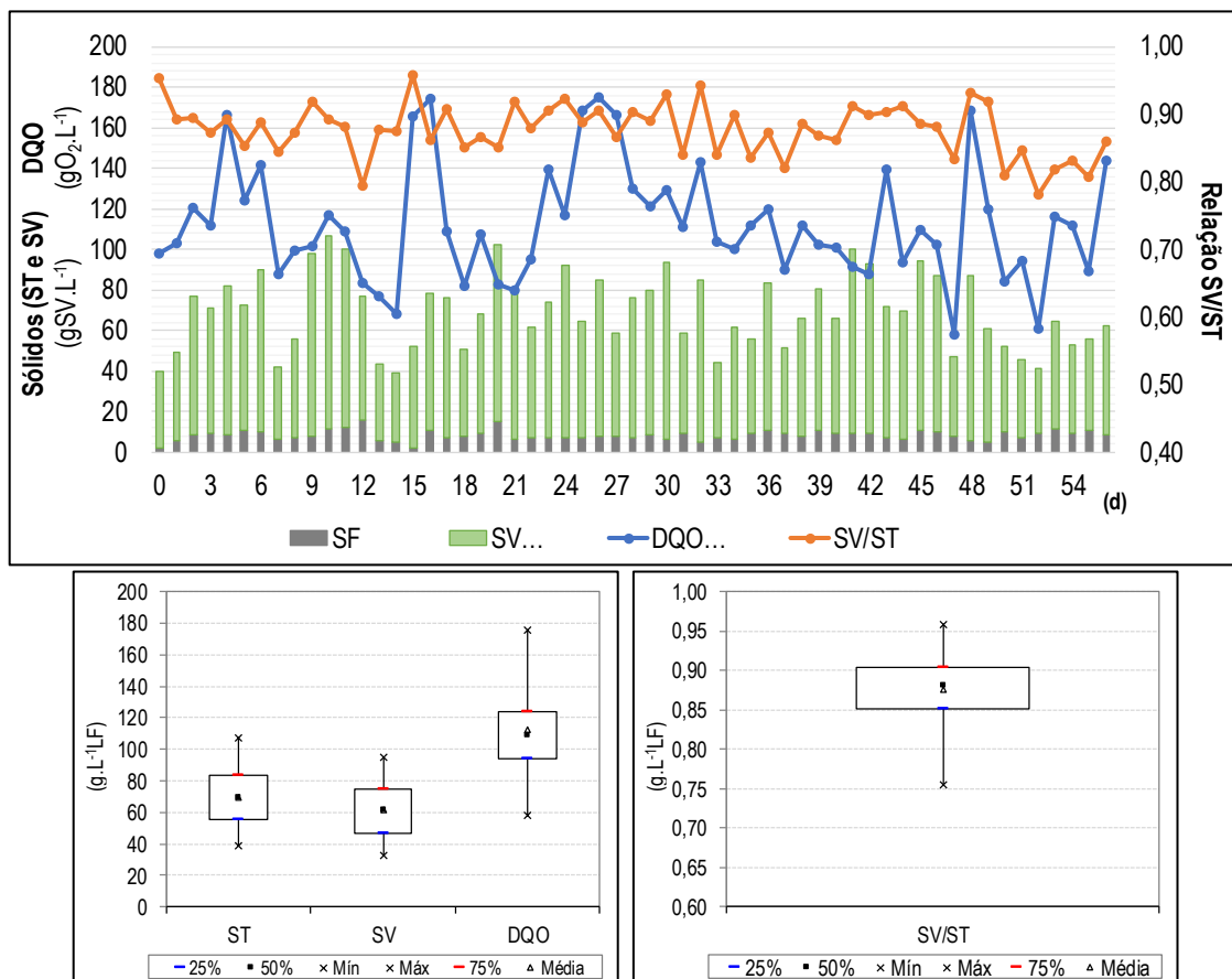
Figura 5.11: Série histórica e box-plot das análises da série de sólidos, relação SV/ST e DQO no excesso de LF contido na FORSU-GG.
