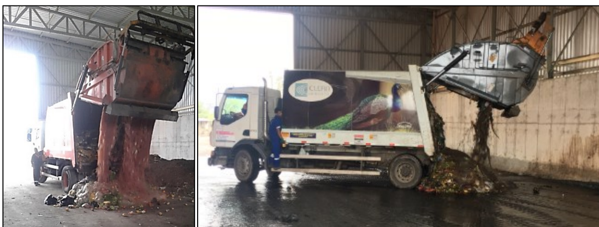
Figura 5.8: Descarregamento da FORSU-GG na unidade MESB e detalhe do excesso de volume de lixiviado fresco (LF) contido nos caminhões de coleta
