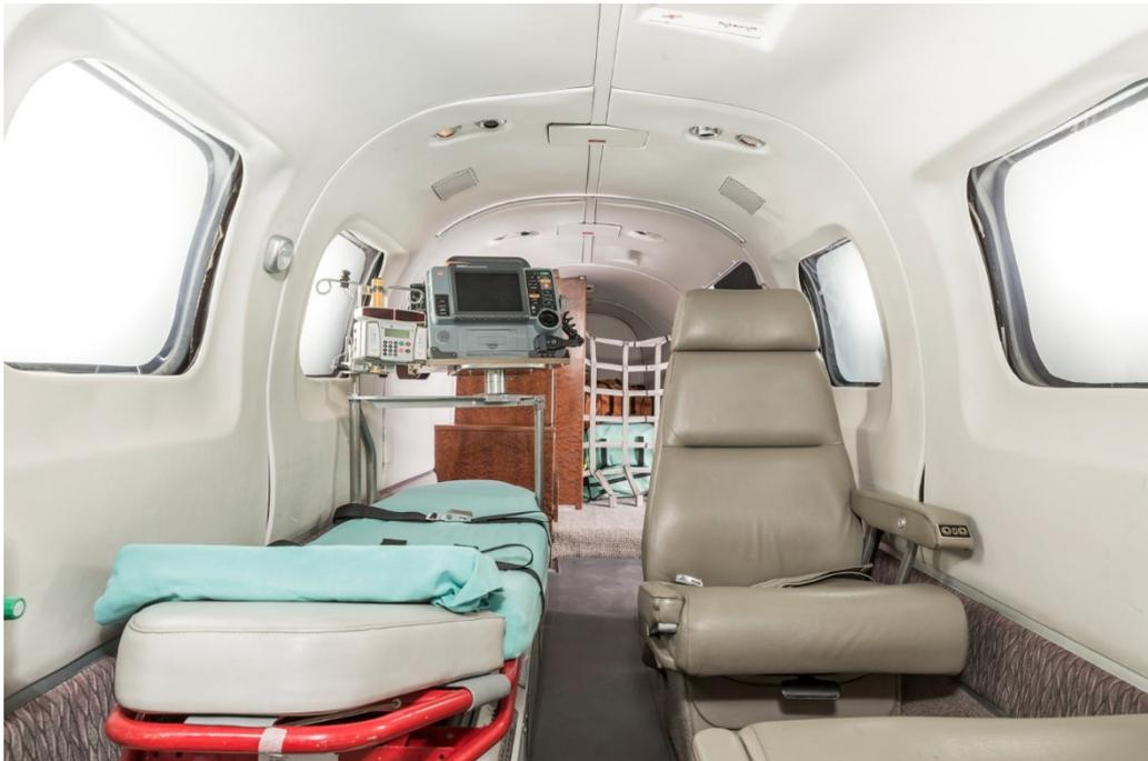
Figura 1- Cabine da aeronave aeromédica, montada com a maca e alguns materiais e equipamentos
