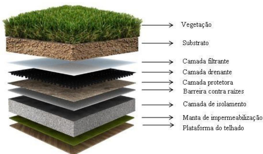
**Figura 1.** Componentes do telhado verde. Fonte: Adaptado de Vijayaraghavan, 2016.
