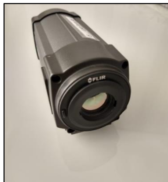
Figura 3: Câmera térmica FLIR A315 usada para realização da coleta dos dados.
