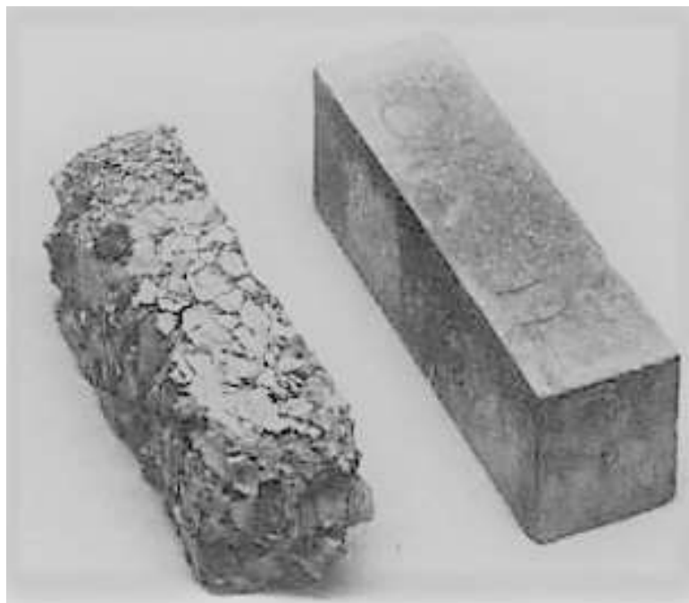
Figura 5- Corpos-de-prova de concreto após 300 ciclos de congelamento e descongelamento. A amostra da esquerda é de concreto convencional, e à da direita foi adicionado um aditivo incorporador de ar.
