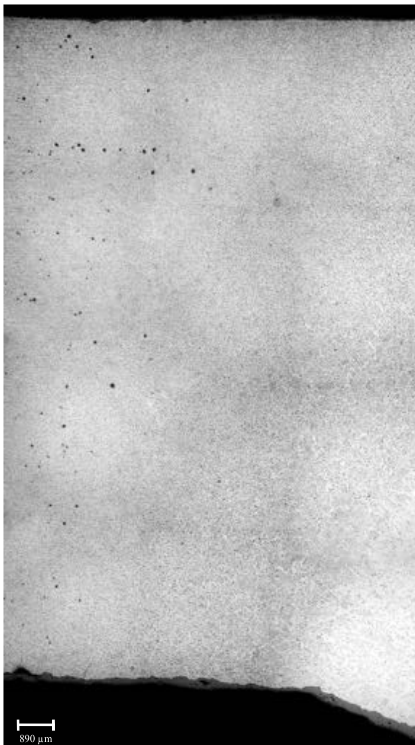
Figura 5-51 –Amostra AM2D: niple . Visão geral da microestrutura do niple próxima a zona termicamente afetada. Verificados agrupamentos de grafita que aparentam seguir o alinhamento gerado no processo de conformação na fabricação. Seção longitudinal. Polimento mecânico. Ataque químico por imersão em Nital 2%.
