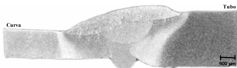
Figura 5-1 – Amostra AM1_A13: macrografia realizada na junta soldada entre o tubo e a curva. Seção longitudinal. Polimento mecânico. Ataque químico por imersão Nital 5%.
