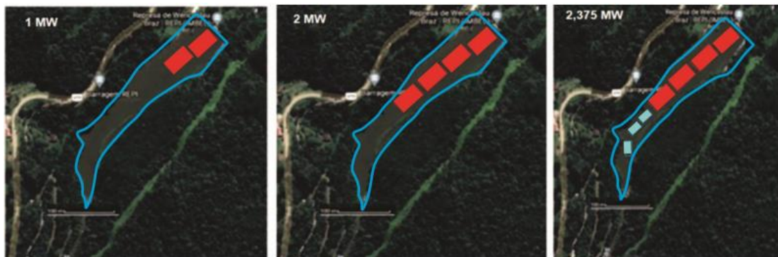
Figura 36 Representação dos painéis flutuantes no reservatório principal
