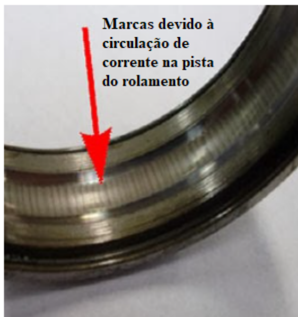
Figura 18 – Rolamento com falha passagem de corrente elétrica
