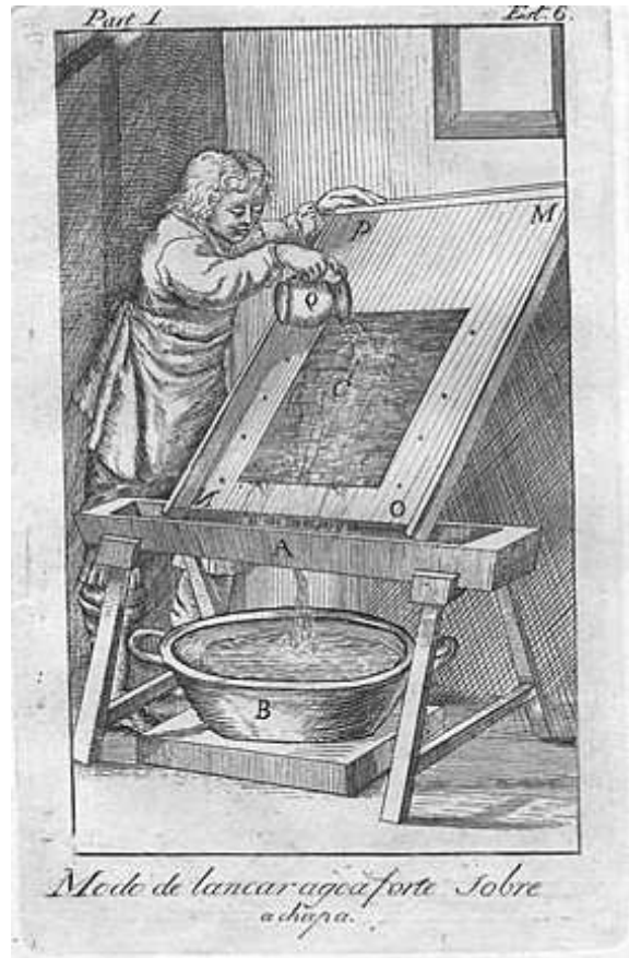
FIGURA 7 - Modo de lançar agua forte sobre a chapa
