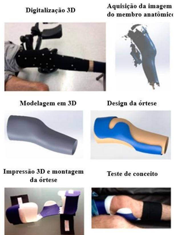
**Figura 2.17-** Aplicação do protocolo para produzir uma órtese de joelho personalizada pela impressão 3D (SANTOS *et al.*, 2017).
