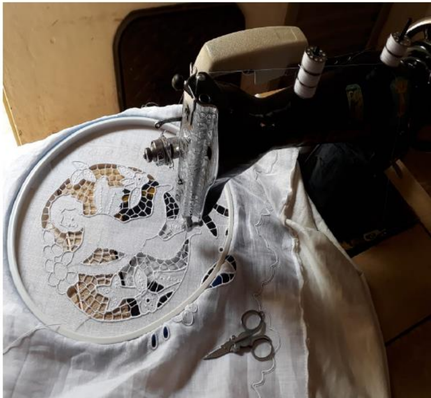
Figura 30 – Processo do bordado feito à máquina (ponto richelieu )
