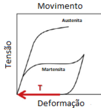
Figura 3.8 – Aplicações de SMAs: Recuperação livre. Fonte: Adaptado (JANI et al. , 2014).
