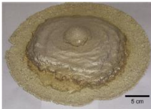
Figura 3.16 – Liga com memória de forma conformada por Spray . Fonte: Adaptado (CAVA et al. , 2014).
