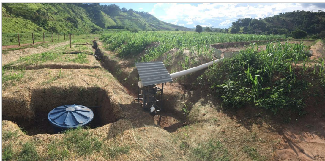
Figura 5.9 - Visão geral do sistema formado por caçamba basculante e caixa coletora implantado na parcela de monitoramento das taxas de erosão situada na região de Barra Longa.
