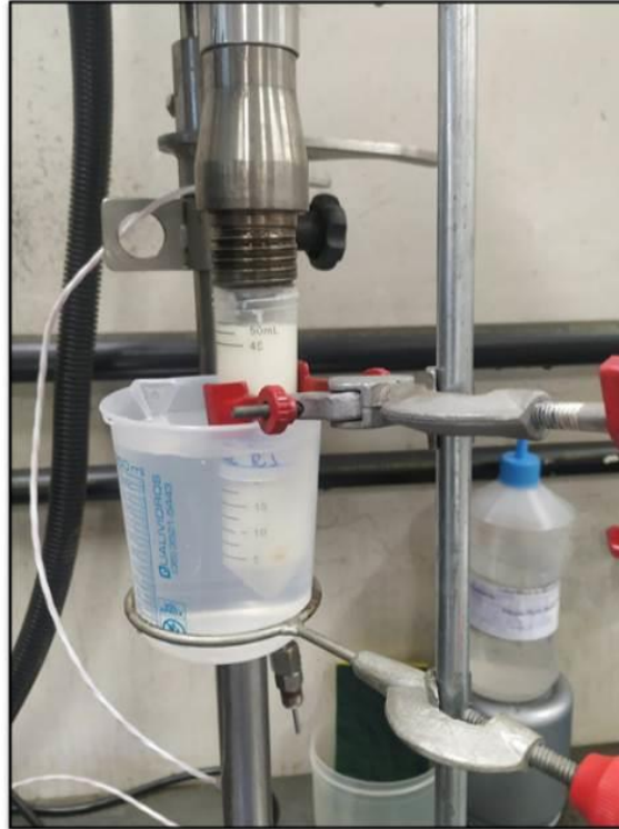
Sonotrodo de ultrassom inserido na amostra sonicada submersa em um béquer com água a temperatura de 25°C. Fonte: dados de pesquisa.
