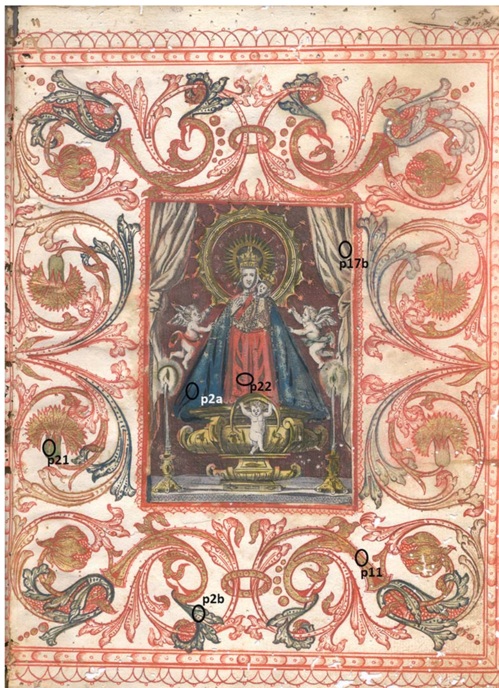
FIGURA 95 – Folha de rosto do TCI de N.S. do Bonsucesso (1738) com os locais dos pontos analisados por fluorescência de raios-X (EDXRF)
