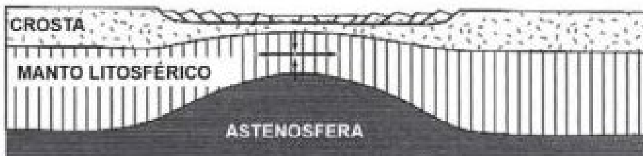
Figura 13 - Modelo geodinâmico de cisalhamento puro para a formação de bacias tipo rifte, proposto por McKenzie (1978), vale observar a simetria da bacia associada a uma deformação homogênea em uma litosfera também homogênea.. Imagem extraída de Roberts et al. (1993).
