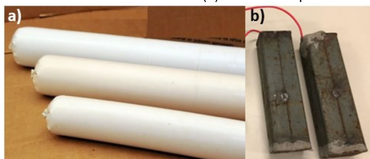
Figura 3: Fotos dos tipos de explosivos mais utilizados em ações criminosas no Brasil. (a) Cartucho de emulsão de nitrato de amônio. (b) Artefato do tipo “Metalon”.
