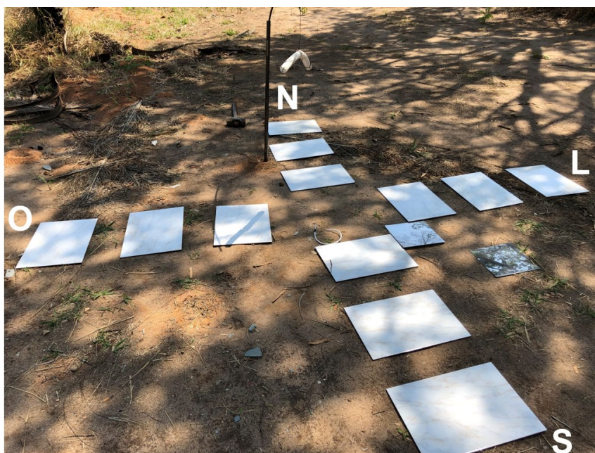
Figura 16: Foto da montagem utilizada para análise de resíduos pós-explosão. Indicação dos pontos cardeais pelas letras N (Norte), S (Sul), L (Leste) e O (Oeste).
