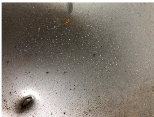
Figura 42: Foto da placa de metal posicionada a 0,5 m da emulsão de nitrato de amônio.
