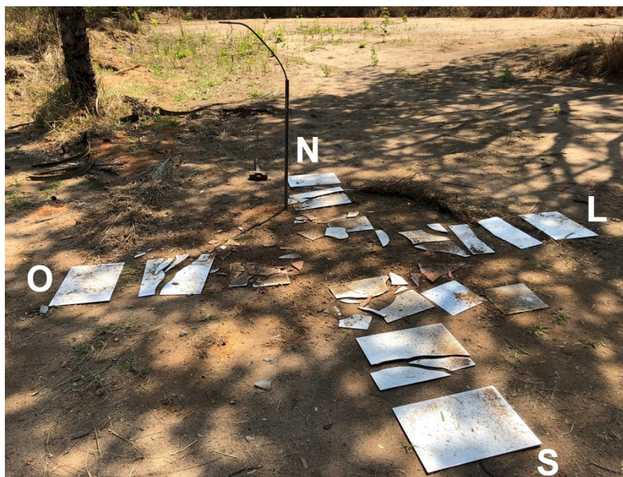
Figura 39: Foto do aspecto final da montagem utilizada para explosão de bisnaga de nitrato de amônio. Indicação dos pontos cardeais pelas letras N (Norte), S (Sul), L (Leste) e O (Oeste).
