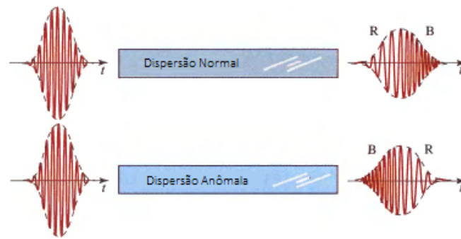
Figura 6 – Propagação de pulso óptico em um meio dispersivo normal e anômalo (SALEH; TEICH, 2019)(Adaptado).
