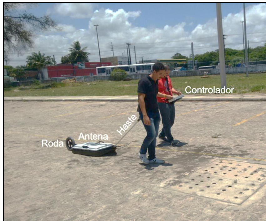
Figura 5 – Equipamento de GPR completo utilizado nos levantamentos de dados desta tese, montado com roda, antena, haste e controlador em operação.
