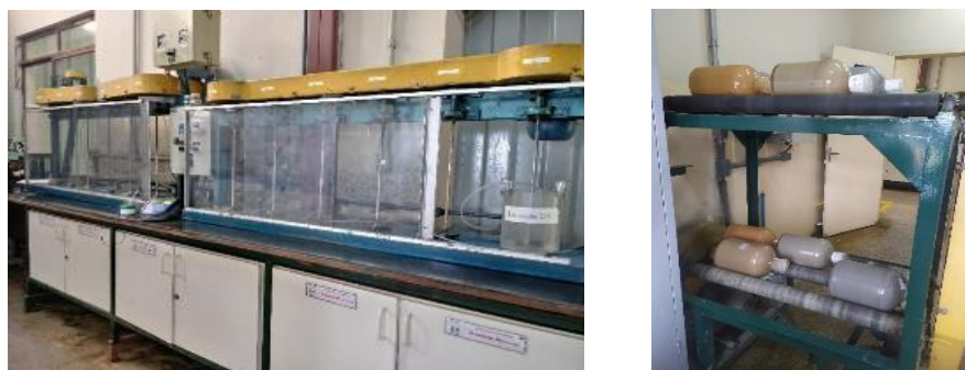
Figura 4.14 - Sistema de agitação para ensaios de lixiviação e testes de adsorção sendo executados em agitadores de garrafas (A autora, 2021).
