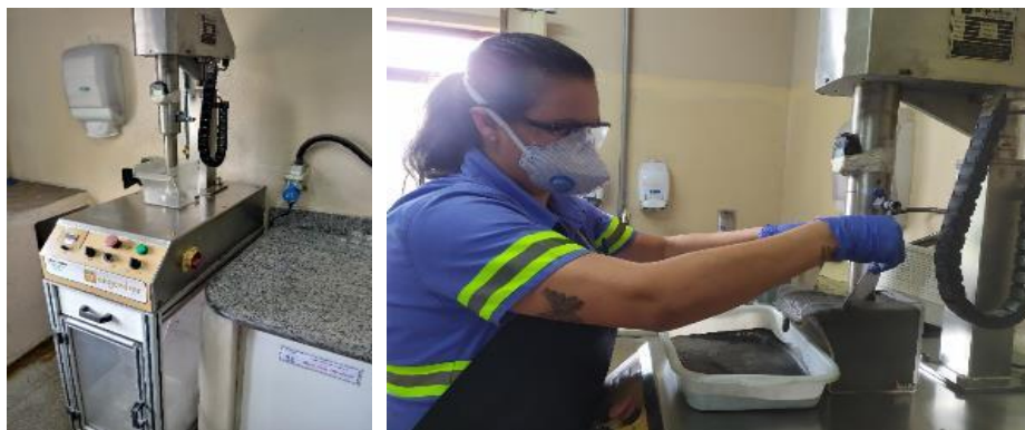
Figura 4.12 - Célula de flotação Engendrar e a laboratorista executando o ensaio de flotação em bancada. (A autora).
