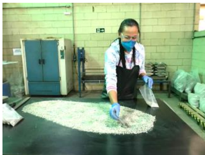
Figura 4.3 - Processo de homogeneização e quarteramento das amostras após a britagem (A autora, 2021).
