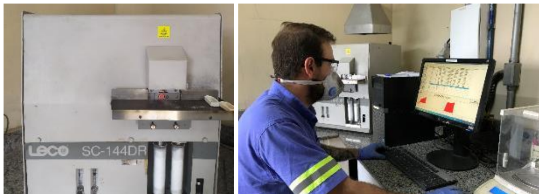
Figura 4.5 - Analisador Leco SC-14DR e o laboratorista realizando a análise de determinação de enxofre. (A autora, 2021).
