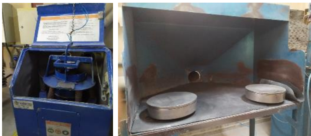
Figura 4.6 - Pulverizador e as panelas utilizadas no processo de fragmentação (A autora, 2021).
