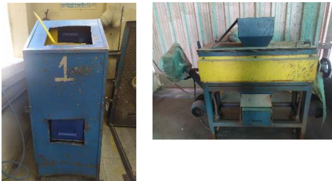
Figura 4.2 - Britador de mandíbulas e de rolos utilizado na fragmentação das amostras (A autora, 2021).
