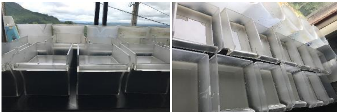
Figura 4.13 - Amostras do rejeito da gravimetria em polpa acondicionados nas cubas de flotação (A autora, 2021).
