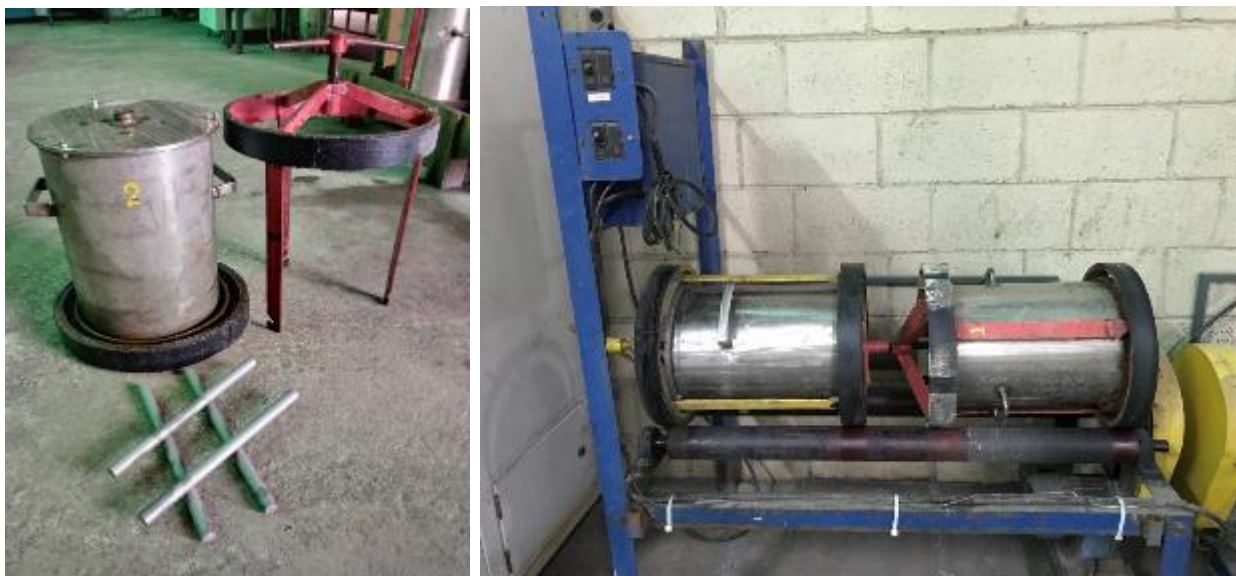
Figura 4.7 - Moinho de barras utilizado nos ensaios e de rolos utilizados nos testes de moagem em laboratório (A autora, 2021).
