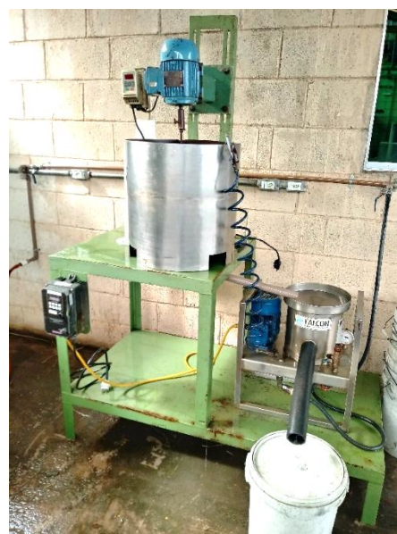
Figura 4.10 - Aparelhagem utilizada na concentração gravítica em laboratório. (A autora, 2021).
