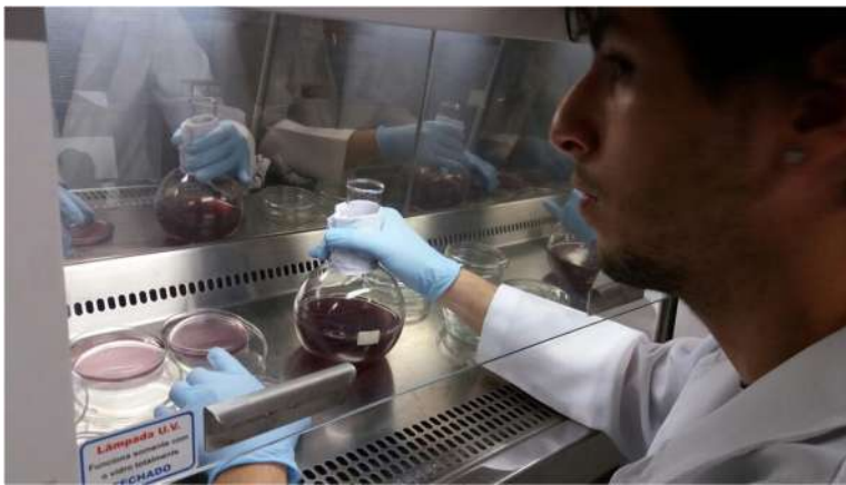
Figura 03 – Preparo do Ágar-Batata-Repolho utilizando a Capela de Fluxo Laminar. Fonte: Acervo pessoal. 2018.
