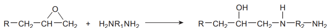
Figura 4: Representação de reação entre amina primária e grupo epóxi durante a reticulação de resinas epóxi [17].
