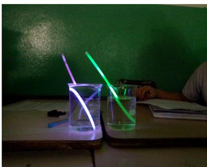
Figura 1- Pulseiras de neon em duas situações: béquer à esquerda com água quente e béquer à direita com água fria.
