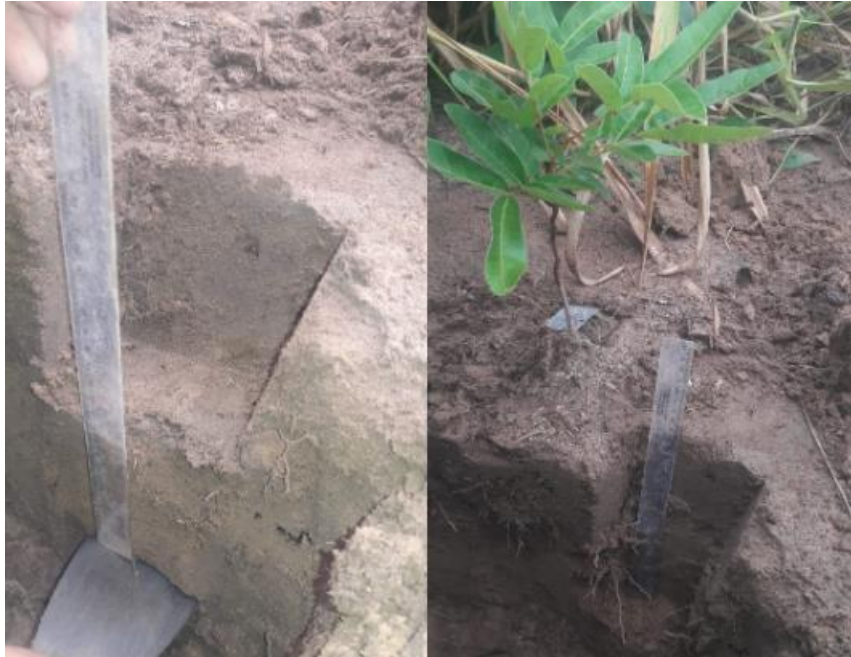
Figura 2 – Amostragem do solo nas profundidades de 0-10 e 10-20 cm para avaliação dos atributos biológicos do solo.
