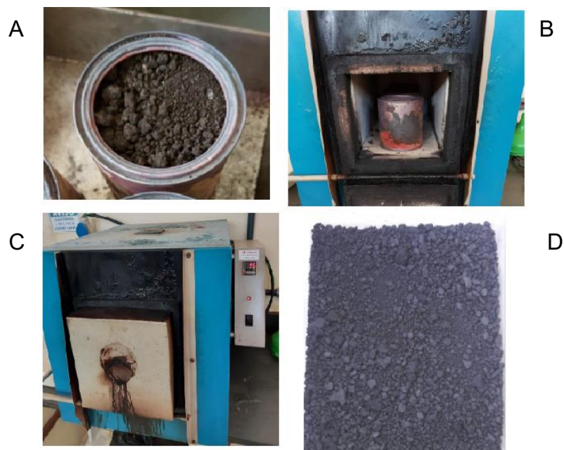
Figura 2 –Torta de Filtro nas latas (B), visão interior da mufla (B), mufla utilizada (C) e biochar de torta de filtro após o processo de pirólise (D).
