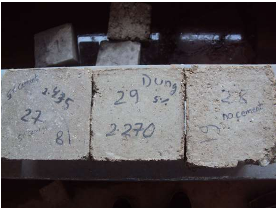
Figura 10 – Aparência física de amostras usando cimento ou esterco ou nenhum deles
