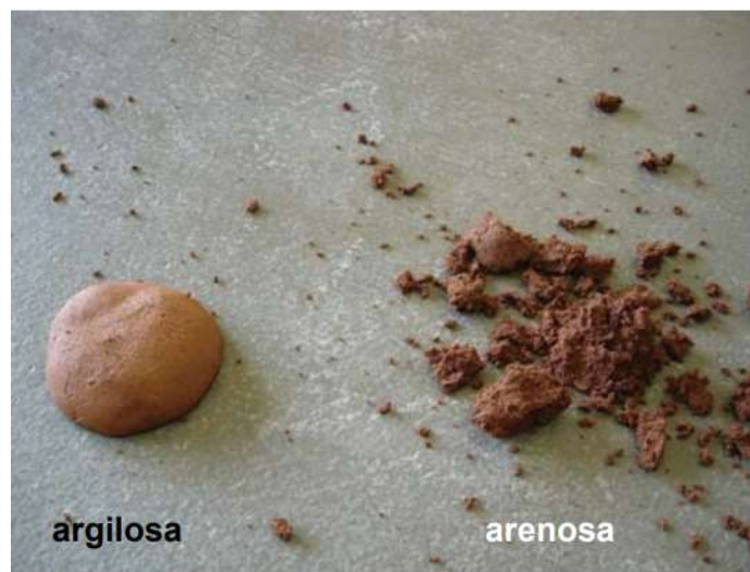
Figura 14 – Teste de queda da bola: aspectos do espalhamento, em função de terra (argilosa, à esquerda e arenosa à direita)
