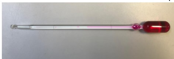
Figura 23 - Termômetro Kata utilizado por Souza (2019) e Bitarães (2019) para a medição da velocidade do ar das salas 315 e 410B da Escola de Arquitetura da UFMG
