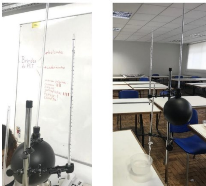
Figura 22 - Termômetros utilizados por Souza (2019) e Bitarães (2019) para a medição de TBS, TBU e temperatura de globo das salas 315 e 410B da Escola de Arquitetura da UFMG
