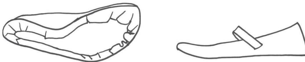
**Figura 33:** Cabedal sobre palmilha de montagem e sapatilha montada.
