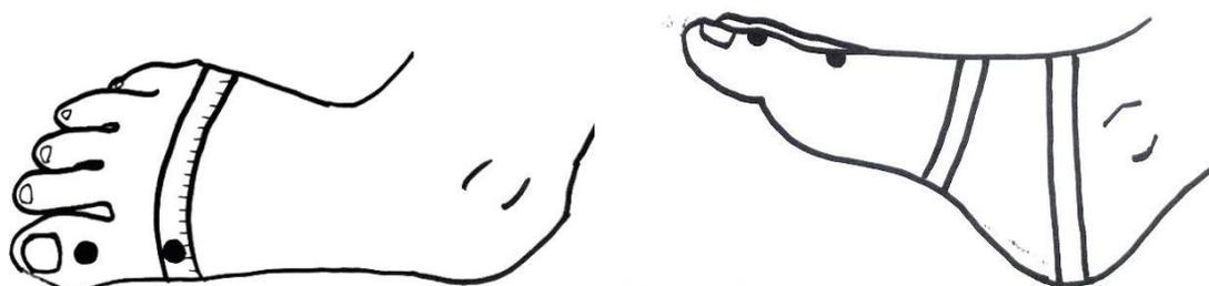
**Figura 29:** Perímetros de medida. Os pontos pretos assinalam o local em que devem ser medidas as alturas do dedão e do joanete. À esquerda, a fita indica o perímetro de maior largura, à direita, os perímetros do arco e do calcanhar.
