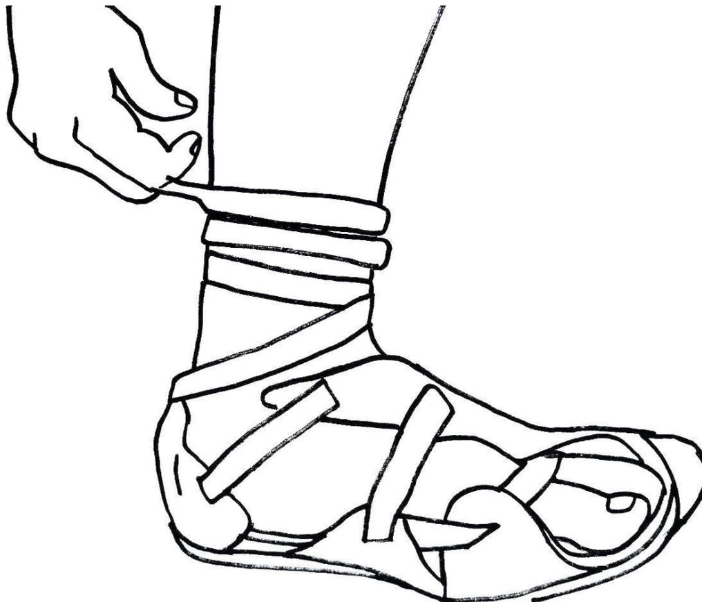
**Figura 118:** Ângulo para ajuste da tira. O pé deve estar inclinado para cima para que o perímetro do círculo que passa do calcanhar ao peito do pé esteja em sua maior extensão, e a sandália não aperte quando em movimento.
