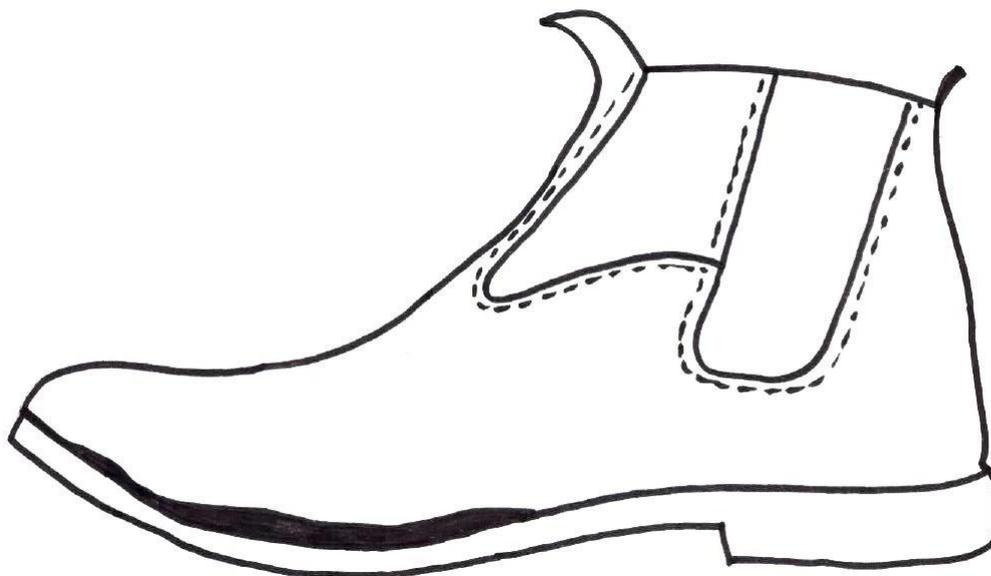
**Figura 44:** Botina com abertura lateral. O rompimento do material se deu pela pressão exercida por um pé cuja largura é maior que a da fôrma com a qual o calçado foi confeccionado.
